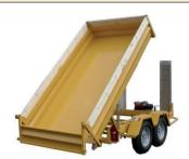
**2 essieux** – PTC de 2000 à 3500 kg basculement par pompe électrique 12 volts
