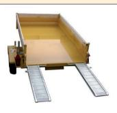
1 porte arrière pour version bennage et 2 rampes de chargement en aluminium avec emplacement à l'avant
